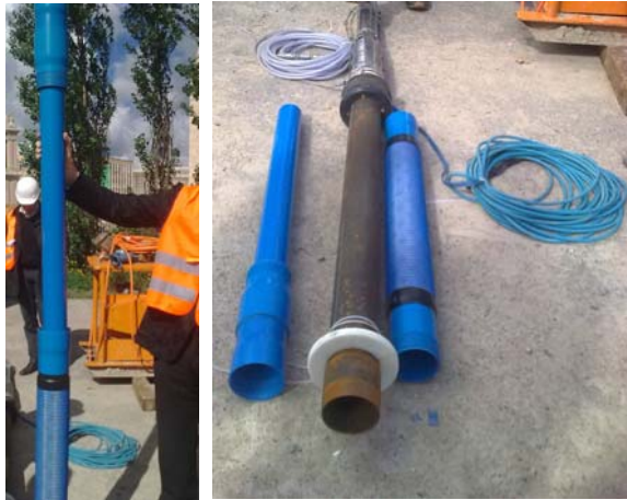
Abb. 3-6: Injektionsdüsen nach Wils (Demonstrationsmaterial Fa. Wils)
